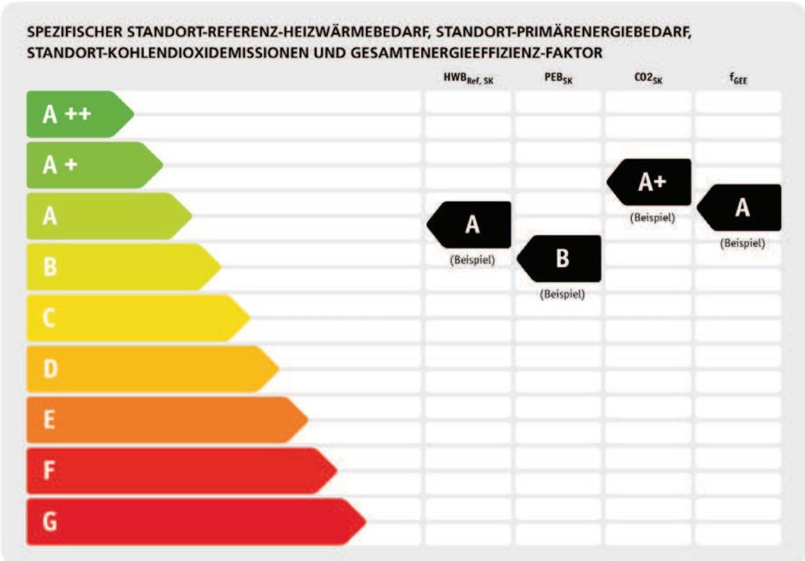
**HWB<sub>Ref</sub>:** Der Referenz-Heizwärmebedarf ist jene Wärmemenge, die in den Räumen bereitgestellt werden muss, um diese auf einer normativ geforderten Raumtemperatur, ohne Berücksichtigung allfälliger Erträge aus Wärmerückgewinnung, zu halten.
